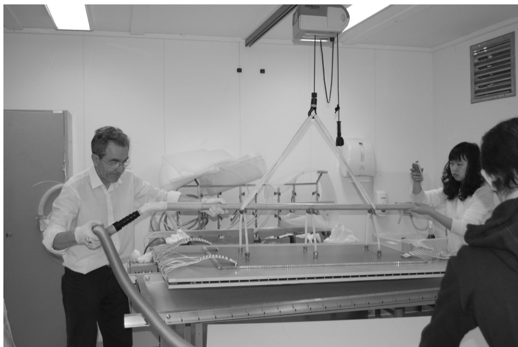
Figura 12 - Sistema di sollevamento del pacchetto finito per aspirazione
