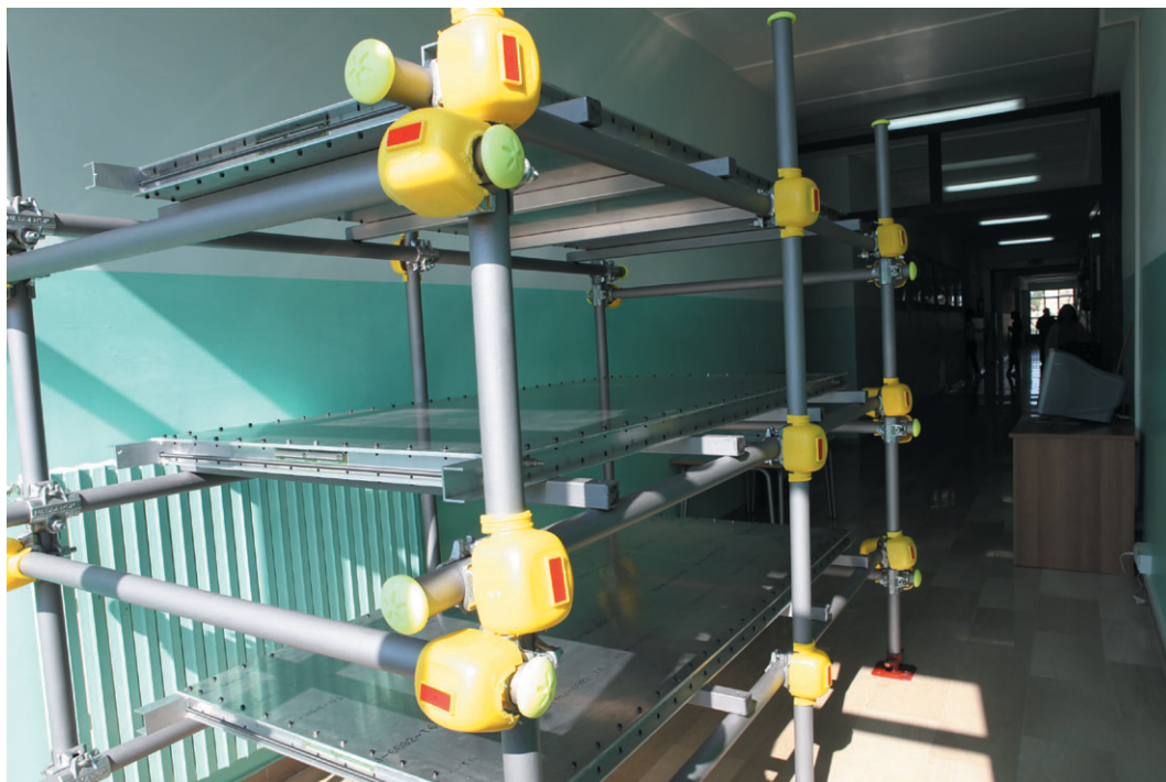
Figura 22 - Le camere appena montate sul castelletto.
